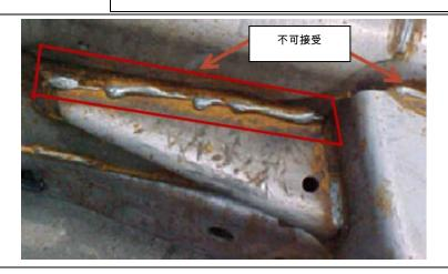
不可接受留有熔渣、氧化皮和腐蚀物。 焊接后的清洁:从所有完成的焊接件 上去除熔渣,并用刷子或通过其他合 适的方式清洁焊件和相邻的基底金 属。清洁操作后残留的顽固溅出物是 可以接受的,除非基于无损检测的目 的要求必须将其移除。在完成焊接并 被验收后,方可对焊缝上漆。
